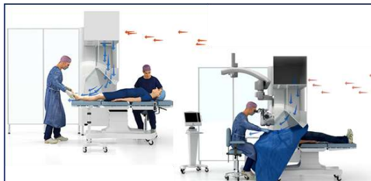
Le traitement d'air s'appuie sur un flux laminaire permanent dirigé sur la surface d'opération et la table à instruments
