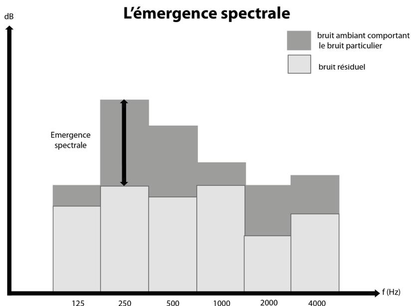
*Note* : certains sonomètres donnent directement les valeurs de l'émergence spectrale par bande d'octave dans les résultats de mesure. Cependant, il ne faut pas oublier de programmer l'acquisition des données par bandes de fréquence avant de faire la mesure.
